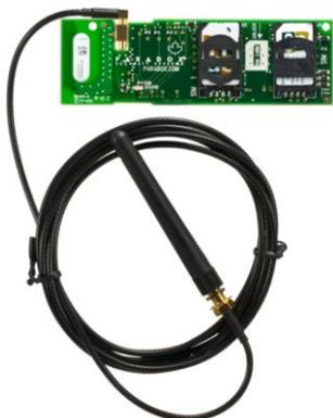
GPRS14 该模块可支持双卡 ( GSM ) 即支持两个不同的 GSM 网络运营商, 在边境地区或者在移动航行的过程中, 单一网络信号经常会很不稳定, 所以在双卡双网络的支持下, 可以做到通讯的无缝切换, 下图为该模块的正面和反面的图片
